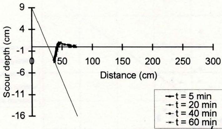
a) Discharge  $1.36 \cdot 10^{-3} \text{ m}^3/\text{s}$ ;  $Y_1=2.54 \text{ cm}$
