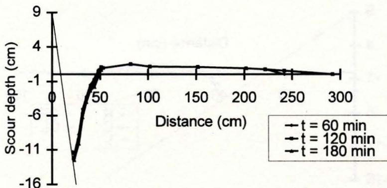
a) Discharge  $2.19 \cdot 10^{-3} \text{ m}^3/\text{s}$ ;  $Y_1=3.02 \text{ cm}$
