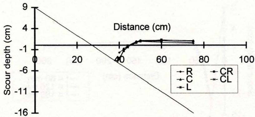
a) Discharge  $1.36 \cdot 10^{-3} \text{ m}^3/\text{s}$ ;  $Y_1=2.54 \text{ cm}$
